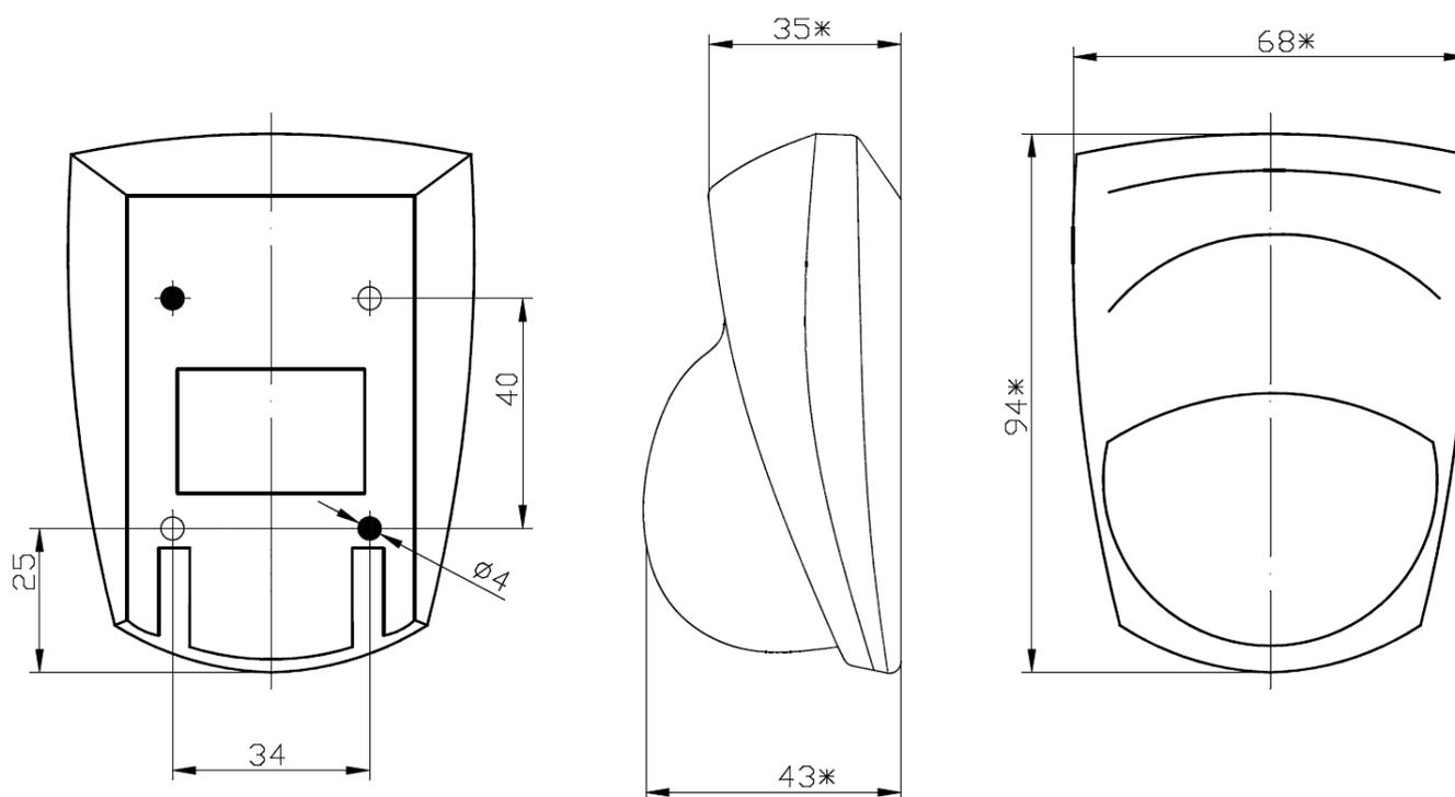
Рис.2.2.2. Внешний вид и основные габаритные размеры извещателя.
