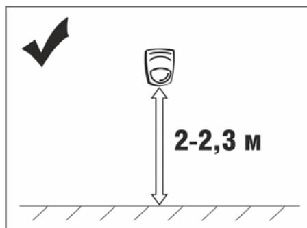
**Рис.2.2.3.9.** Устанавливайте извещатель на высоте 2-2,3м над полом.
