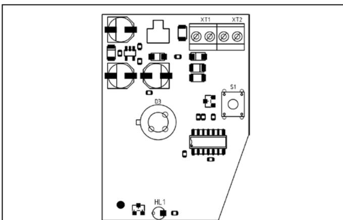
**Рис.2.2.4.1.** Внешний вид печатной платы извещателя (XT1, XT2 – клеммная колодка; S1 – тампер; HL1 – светодиод;)
