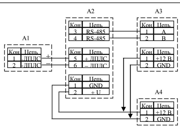
**Рис.2.2.4.2.** Схема подключения извещателя к контроллеру «С2000-КДЛ» (A1 – извещатель; A2 – «С2000-КДЛ»; A3 – пульт контроля и управления «С2000»; A4 – источник питания 12В)
