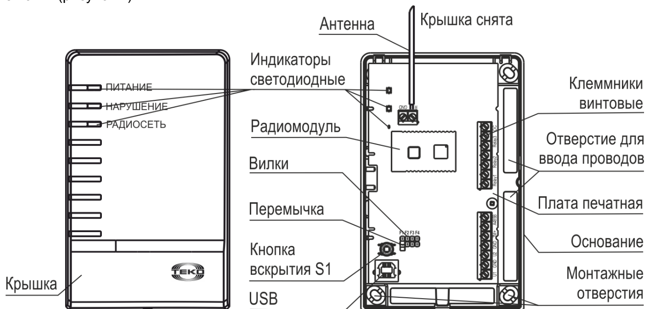
Рисунок 2. Конструкция Астра-ПИ-М РР
